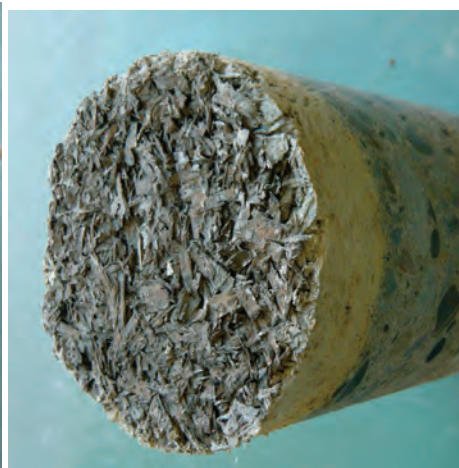
写真. 5. 3 34年経過した木毛セメント板打込み面の中性化深さの例 (ピンク色の部分は未中性化部分、右側下面は木毛セメント板面)
