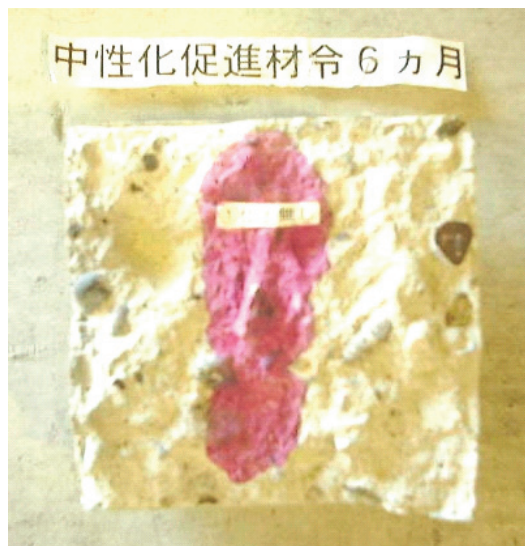
写真. 5. 1 コンクリート打放し 写真. 5. 2 木毛セメント板打込み 中性化促進試験結果 (促進材令6ヶ月)
